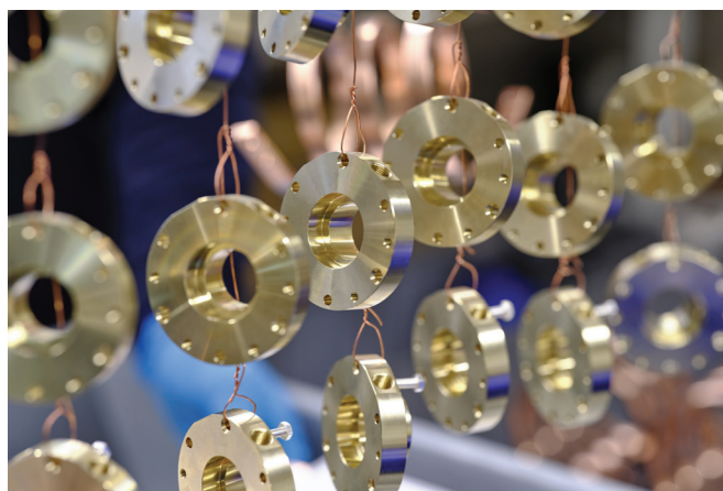
Pièces préparées pour le processus de traitement de surface chez R. Schlierholz
