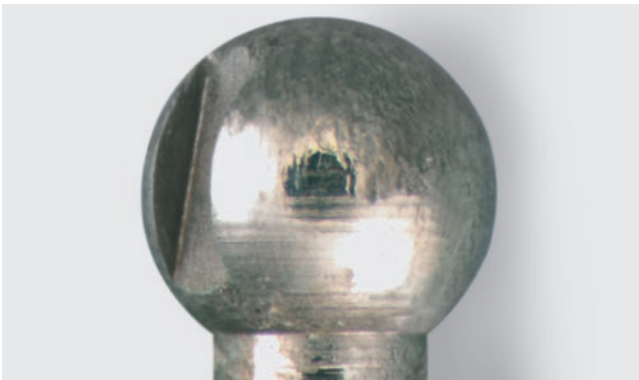
Effet d'une partie femelle en matière plastique : Endommagement important et irréparable de la partie mâle par des substances incrustées dans la matière plastique.
