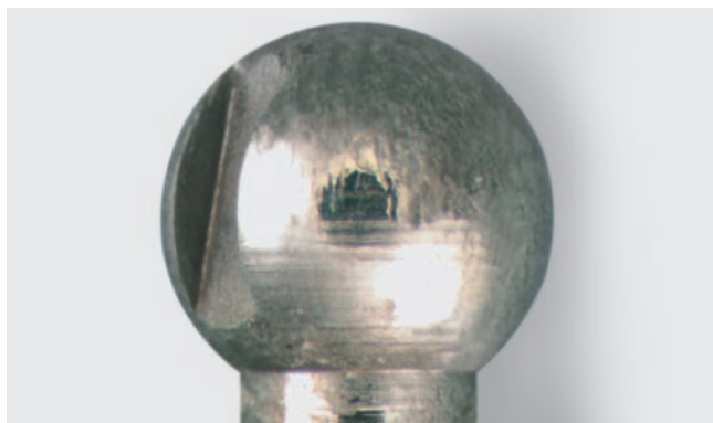
Effetto di una femmina in plastica Danneggiamento irreparabile del maschio causato da sostanze incluse nella plastica.
