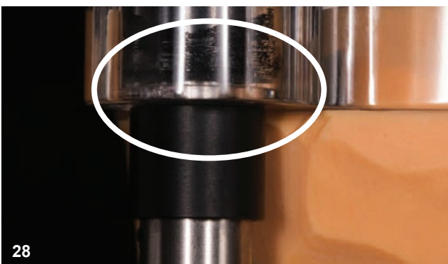
Achten Sie stets darauf, dass sich der Vertikulator vollständig in seiner geschlossenen Ausgangsposition befindet, bevor Sie fortfahren. Abb. 28
