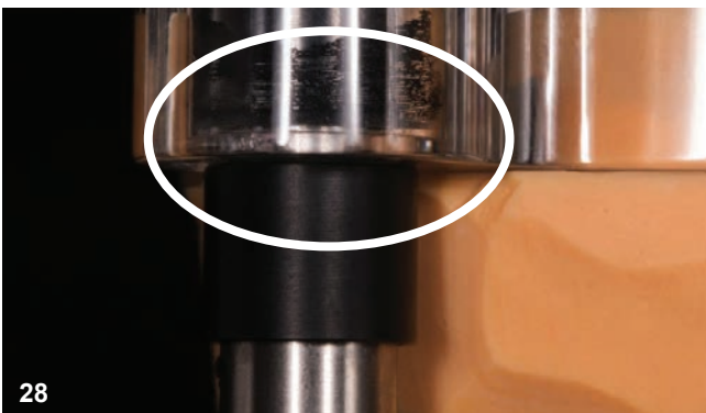
Verificare sempre che il verticolatore si completamente chiuso in posizione iniziale prima di procedere. Fig. 28
