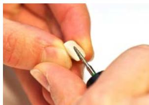
Tras el trabajado con las fresas, la estructura se chorrea con un abrasivo de 110  $\mu\text{m}$  a una presión de 2 bar y después se limpia bien con aire comprimido exento de aceite.
