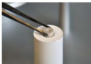
Colocar el émbolo de prensado en la mufla con la junta de goma hacia abajo.
