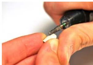
Antes del chorreado, la superficie se aumenta en rugosidad con ayuda de una fresa de diamante y se limpia con alcohol.
