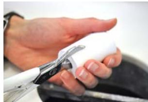
El desenmuflado fino se lleva a cabo con un abrasivo de corindón de 110 µm y una presión de 2 bar.
