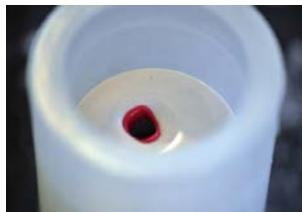
Con un pincel humedecido (para no absorber humedad de la masa), revestir la cavidad cuidadosamente.
