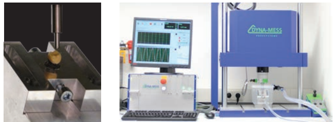
Figure 2: spécimen dans le porte-objet; l'extrémité du pilier d'appoint utilisé pour la mise en charge se situe au centre du plan occlusal (à gauche). Appareil de mesure «Dyna-Mess TP 5kN HF» utilisé pour les essais de fatigue (à droite).
