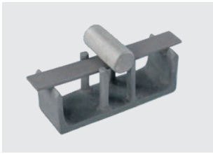
Mesure de la déformation: Après simulation des cycles de cuisson de la céramique
