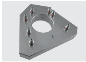
Nachweis der Passgenauigkeit: Getestet auf starren Stahlmodellen mit Implantaten
