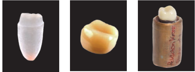
Figura 1: Muñón realizado en PMMA (izquierda), corona del molar revestida con estructura de Pekkton® ivory (centro), muestra incrustada en un tubo de cobre corto a la altura de la línea amelocementaria (derecha).
