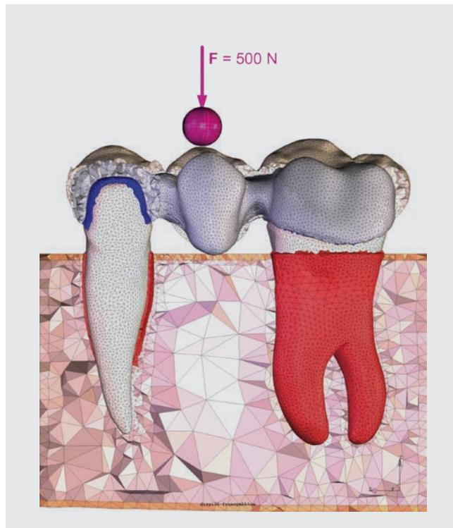
Figura 1: Modello FE del ponte di 3 elementi.
