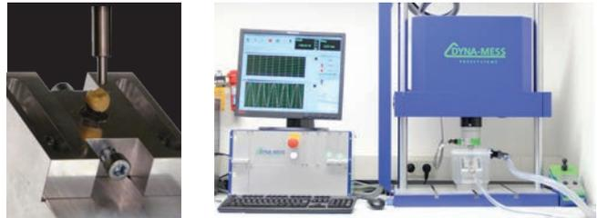
Figura 2: Provino nel portacampioni; la punta del punzone di spinta usato per il carico è posizionato al centro del piano oclusale (a sinistra). L'apparecchio di misurazione «Dyna-Mess TP 5kN HF» usato per le prove di fatica (a destra).
