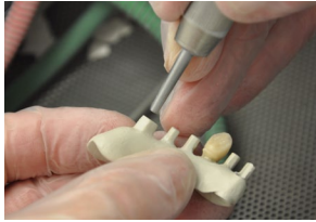
크기 110 \mu m 및 압력 2 - 3 bar.의 미 재생 산화 알루미늄( Al_2O_3 )으로 플라스틱 치아를 샌딩하십시오. Pekkton® ivory 프레임을 크기 110 \mu m 및 압력 2 bar의 미 재생 산화 알루미늄( Al_2O_3 )으로 샌딩하십시오. 최종적으로 오일 미첨가 압축 공기 혹은 알코올로 세척하십시오. 스팀 세척하지 마십시오!
