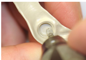
Pekkton® ivory 표면을 다이아몬드로 그라인딩 하십시오. 낮은 회전속도와 적은 압력으로 작업하십시오. 분당 5'000 - 10'000 회전속도가 권장됩니다. 알코올로 세척합니다
