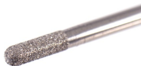
Pekkton® ivory 표면을 다이아몬드로 그라인딩 하십시오. 낮은 회전속도와 적은 압력으로 작업하십시오. 분당 5'000 - 10'000 회전속도가 권장됩니다. 알코올로 세척합니다
