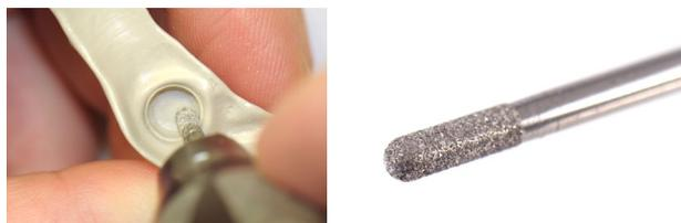
Conferir rugosidad a la superficie de Pekkton® ivory con una fresa de diamante. Emplear una velocidad de giro reducida y una presión reducida. Se recomienda una velocidad de giro de entre 5000 y 10.000 rpm. Limpiar con alcohol.
