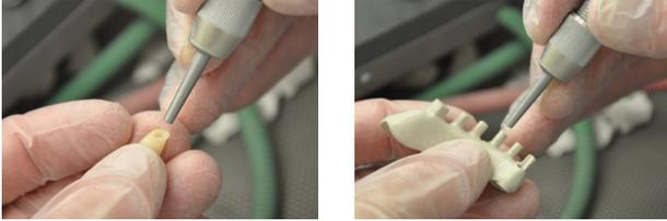
Chorrear los dientes artificiales con óxido de aluminio no reciclado ( $Al_2O_3$ ) con un tamaño de grano de  $110\ \mu m$  y una presión de 2 – 3 bar. Chorrear las estructuras de Pekkton® ivory con óxido de aluminio no reciclado ( $Al_2O_3$ ) con un tamaño de grano de  $110\ \mu m$  y una presión de 2 bar. A continuación, limpiar con aire a presión libre de aceite o con alcohol. ¡No utilizar un limpiador de vapor!
