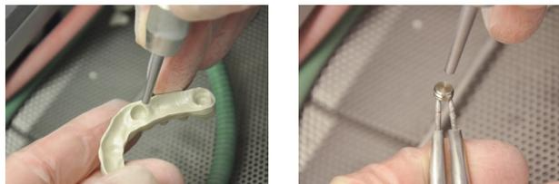
Chorroar la estructura de Pekkton® ivory con óxido de aluminio no reciclado ( $Al_2O_3$ ) con un tamaño de grano de 110  $\mu m$  y una presión de 2 bar. A continuación, limpiar con aire a presión libre de aceite o con alcohol. ¡No utilizar un limpiador de vapor!
