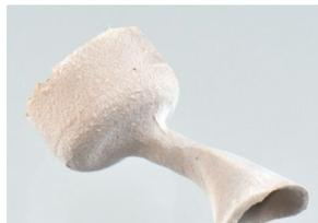
El desenmufado hasta se realiza con tenazas teniendo precaución. El desenmufado se realiza en cuanto la mufla está tibia. En las piezas más grandes, no desenmuffar con tenazas. El desenmufado fino se lleva a cabo con un abrasivo de corindón de 110  $\mu\text{m}$  y una presión de 2 bar.
