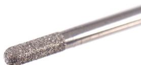
Conferir rugosidad a la superficie con una fresa de diamante. Emplear una velocidad de giro reducida y una presión reducida. Se recomienda una velocidad de giro de entre 5000 y 10.000 rpm.
