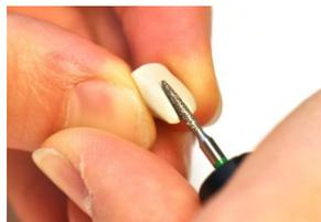
Mediante fresas de dentado cruzado se le confiere la forma definitiva a la estructura. El repasado se realiza a 5000 - 10.000 rpm como máximo. No trabajar con una presión demasiado elevada sobre el objeto. Antes del chorreado, se crea rugosidad en la superficie con ayuda de una fresa de diamante. Limpiar con alcohol.
