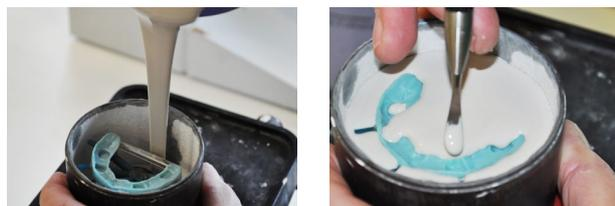
Rellenar con cuidado el anillo de la mufla con la masa de revestimiento de forma que se vierta con un fino chorro hasta alcanzar el borde de los objetos de cera. Con un pincel humedecido (para no absorber humedad de la masa), revestir la cavidad cuidadosamente. Para ello también se puede utilizar una sonda fina teniendo cuidado de no dañar los delicados bordes de la cera.
