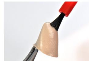
Tras el repasado con las fresas, la estructura se chorrea con un abrasivo de 110  $\mu\text{m}$  a una presión de 2 bar. Limpiar con alcohol. Antes del revestimiento, la estructura de Pekkton® ivory debe tratarse obligatoriamente con imprimador (primer) para composites a base de MMA.
