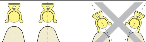
Afin d'éviter une désactivation prématurée des lamelles et assurer en même temps une insertion et un retrait corrects de la prothèse, les parties femelles doivent être parallèles.
