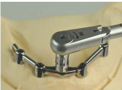
Couple de serrage du CM LOC® CAD/CAM Retaining Element > 35 Ncm.
