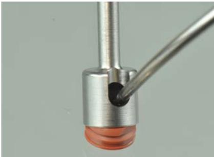
Ensuite, extraire le CM LOC® Housing par l'ouverture latérale avec un instrument du CM LOC® Housing Extractor.
