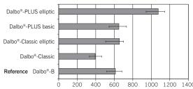
Todas las matrices de bola muestran una retención suficiente en el cuerpo de la prótesis en condiciones de laboratorio. Cabe subrayar el alto valor de la matriz Dalbo® PLUS elliptic, que en algunos casos incluso supera las propiedades mecánicas del plástico.
